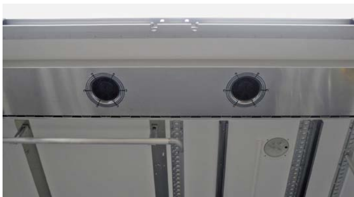
In Kühlfahrzeugen ist durch 24-V-Luftwandanlagen ein im Gegensatz zu Schiebetüren oder Streifenvorhängen barrierefreies Be- und Entladen möglich.
